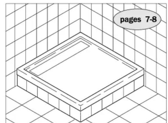
Montaż na nośniku styropianowym
